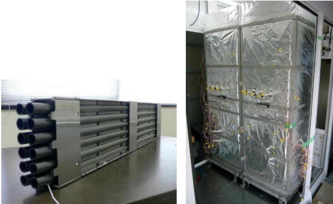
図7 SOFC スタックおよびモジュール外観写真
